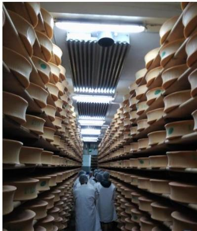
Figura 9. Equipo estático para la gestión de las condiciones ambientales (humedad relativa, temperatura y velocidad de aire) en la cámara de maduración
