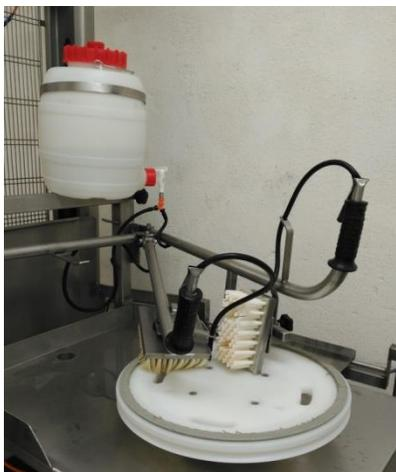
Figura 13. Cepilladora manual para el cepillado superficial de los quesos, junto con depósito de solución de lavado
